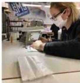
La fase di cucitura e plissettatura dei 9 strati di tessuto predefinitamente tagliati con taglio automatico
