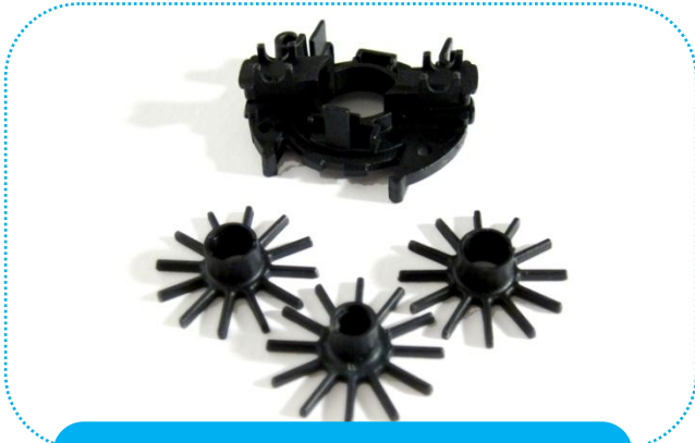
电机组件 RADILON®A RV350 HHR 3800 NERO PA6.6, 优异的耐热老化性能, 绝缘等级 H (180°).
